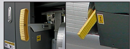
2 palancas, adelante y atrás, que facilitan el montaje del material.
